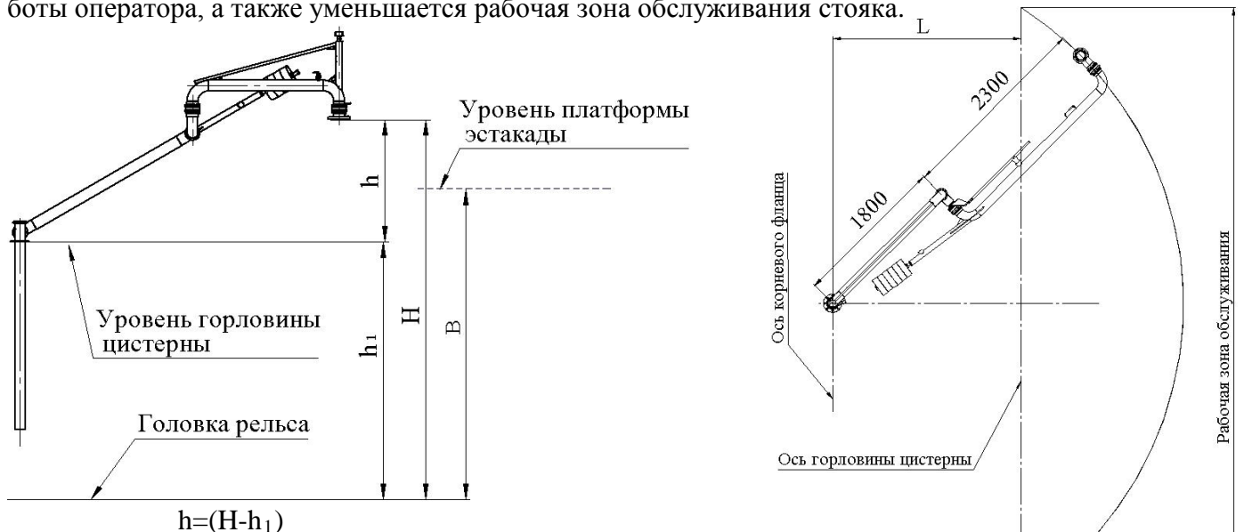
Рис. 2. Рабочая зона обслуживания стояка ОСН-СВН-100-Н-6-НН.
